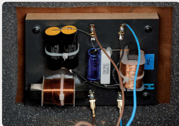
La frequenza di crossover è pari a 1,3 kHz.
