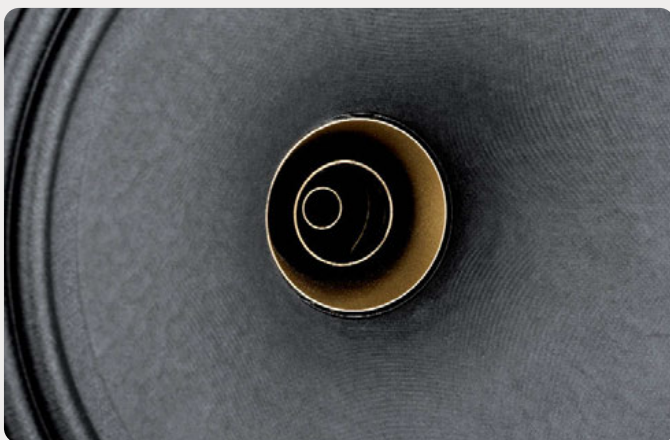
Primo piano delle piccole trombe del tweeter.
